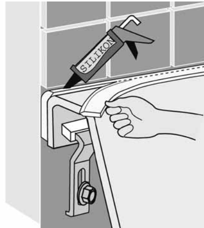
Герметизация с использованием звукоизоляционной ленты и силиконового шва
