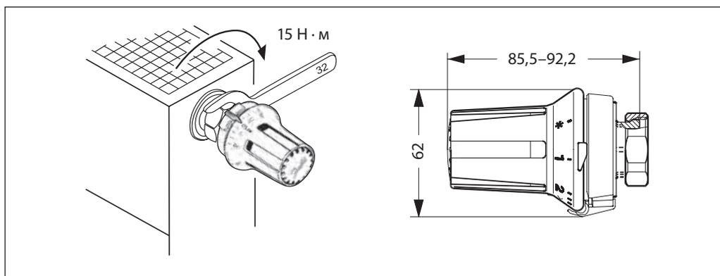
Монтаж термостатического элемента серии RAW-K на клапан терморегулятора производится легко и быстро с помощью соединительной гайки М 30 x 1,5.
