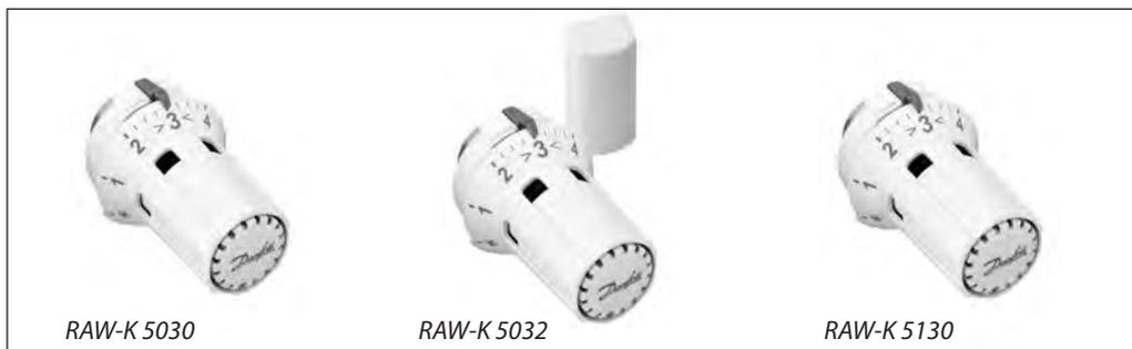
Термостатические элементы серии RAW-K — автоматические регуляторы температуры с малой зоной пропорциональности. RAW-K предназначены для установки на клапаны терморегуляторов фирм Heimeier, Oventrop или MNG, встроенные в конструкцию стальных панельных радиаторов типа Biasi, Delta, DiaNorm, Diatherm, Ferroli, Henrad, Kaimann, Kermi, Korado, Purmo, Radson, Superia, Stelrad, Veba, Zehnder-Completo Fix.
