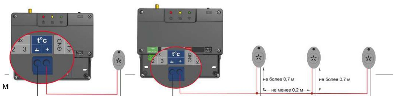
**ВНИМАНИЕ!!!** На кабельные линии (шлейф) цифровых датчиков действуют импульсные сетевые помехи. Запрещается прокладывать провода, к которым подключены датчики в одном кабельном канале с силовыми кабелями
