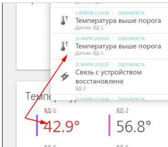
Для радиодатчиков ZONT индицируется выход за пределы минимальных и максимальных значений параметров, уровень радиосигнала и напряжение батарейки радиодатчиков.
