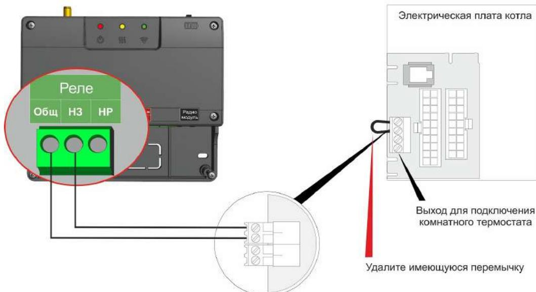
**Вариант 2:** На клеммах котла, предназначенных для подключения термостата, нет перемычки и котел выключается при ее установке. В этом случае необходимо подключить подключить 1 и 3 контакты релейного выхода.
