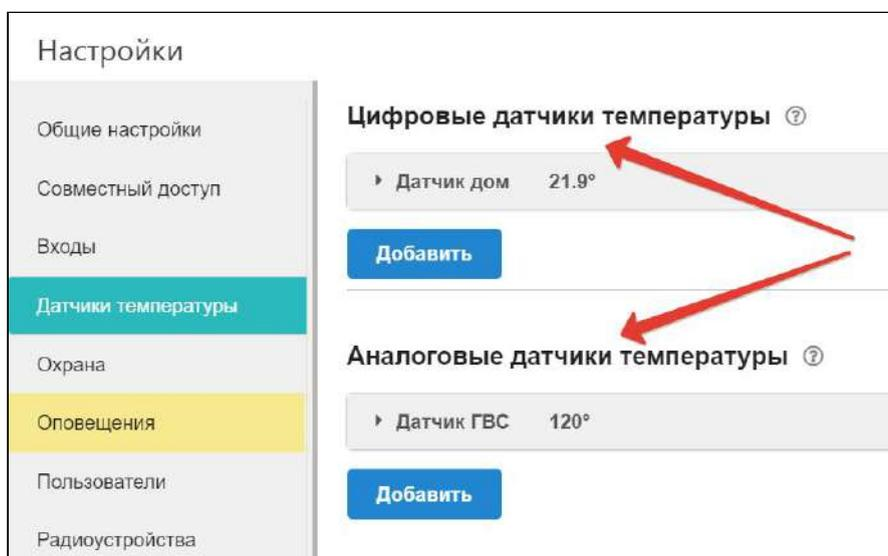
**Цифровые датчики** подключаются к клеммам “t C” Контроллера с соблюдением полярности. При необходимости подключения нескольких цифровых датчиков температуры DS18S20 их нужно собирать в шлейф (подробнее в [п.1 “Подключение проводных цифровых датчиков температуры” Приложении 4](#)). После подключения датчики обнаруживаются автоматически и появляются на вкладке настроек “Датчики температуры” — “Цифровые датчики температуры”.
