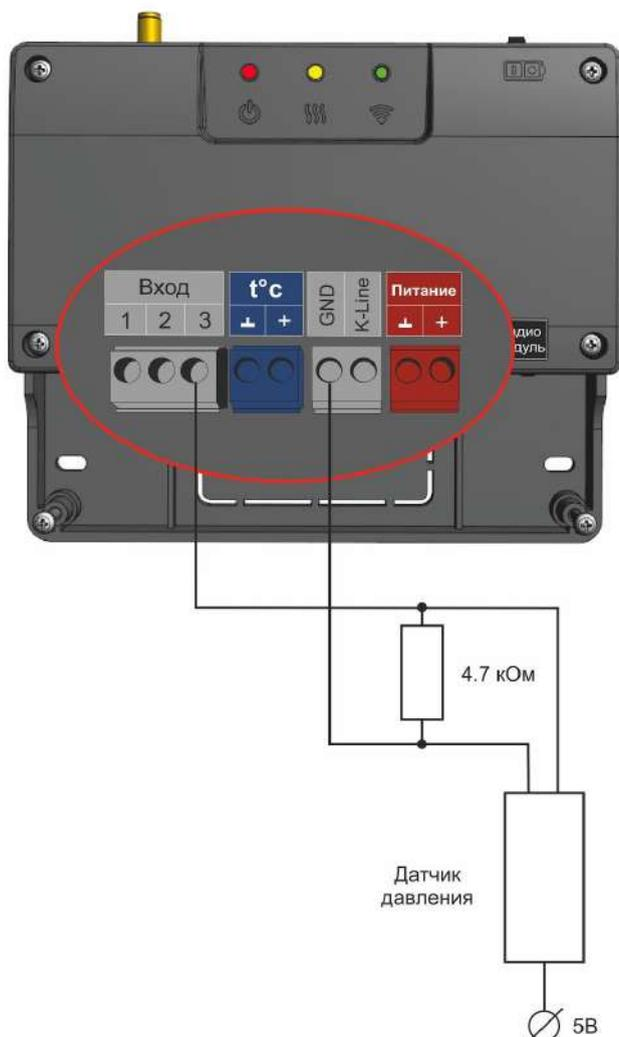
Номинальное напряжение на выходе датчика — от 0,5 В до 4,5 В. Опорные точки:
