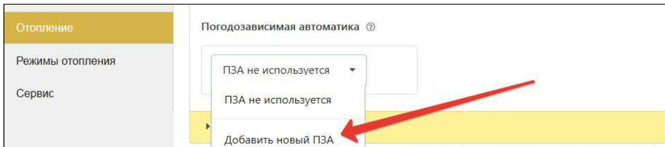
Настройка позволяет моделировать кривую зависимости температуры теплоносителя от уличной температуры (кривую ПЗА) с целью поддержания в помещении целевой температуры.
