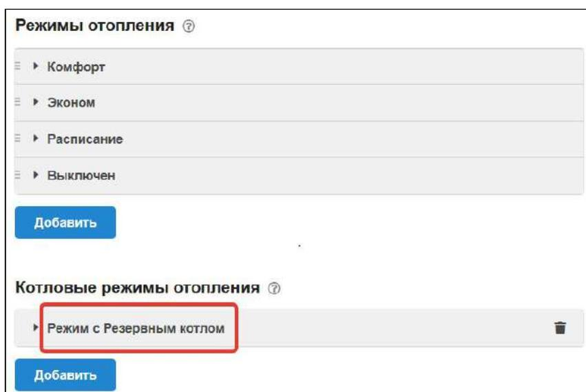
В Настройке Котлового режима обязательно укажите датчик, по которому контролируется фактическая температура теплоносителя и будет приниматься решение об остановке (аварии) основного котла и необходимости включения резервного.
