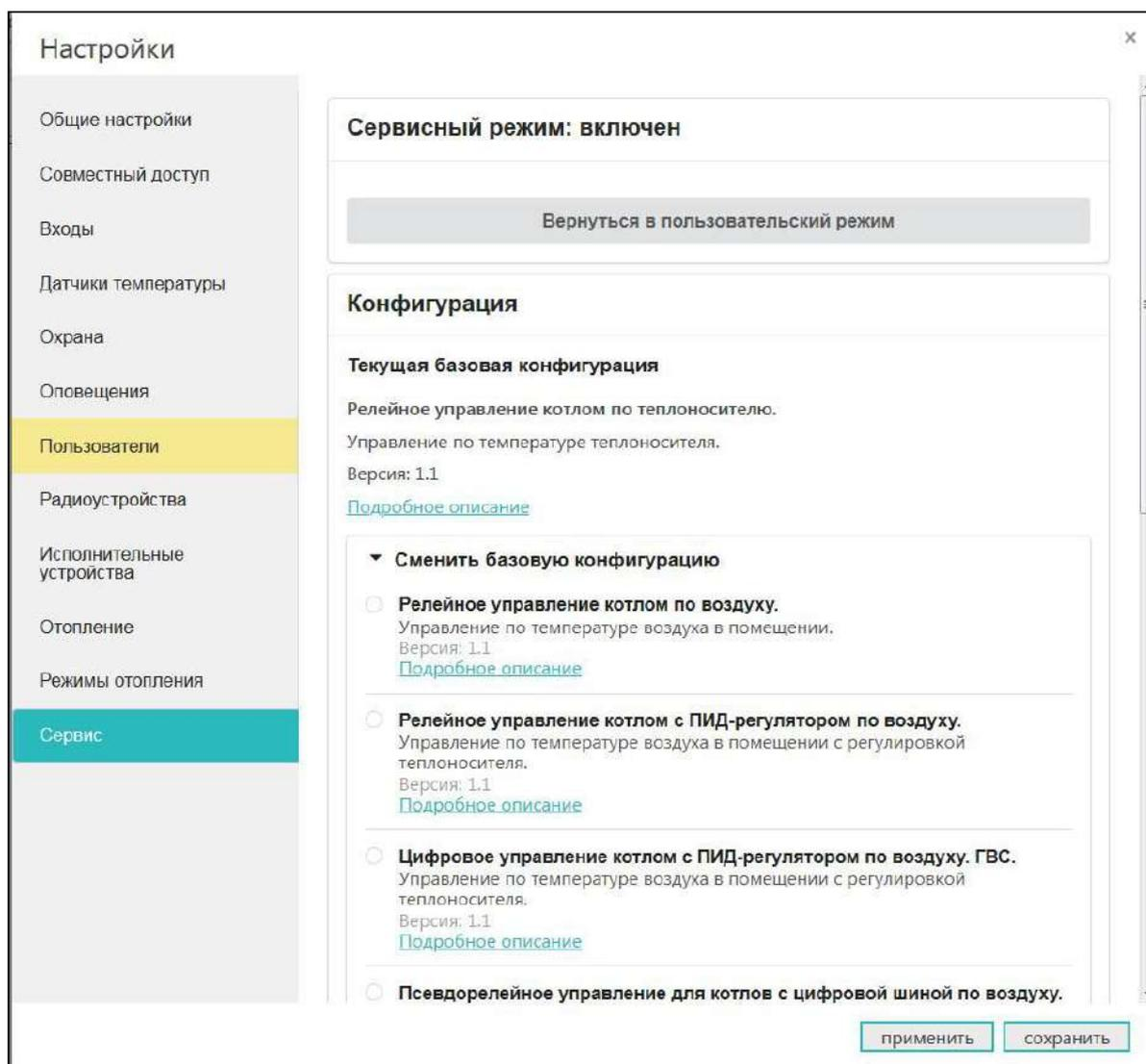
Для быстрой настройки Контроллера по одной из типовых конфигураций, необходимо выполнить подключения по рекомендуемой схеме и выбрать ее из предложенного списка. Далее нажать кнопку “применить”. Порядок подключения оборудования, датчиков доступны для просмотра при нажатии на ссылку “Подробнее описание” конкретной конфигурации.
