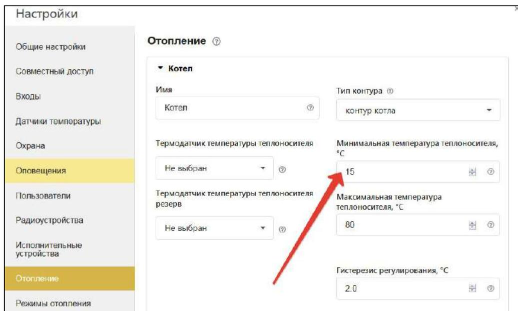
Значение для настройки выбирается исходя из физических свойств (температуры кристаллизации) используемого теплоносителя (вода, антифриз и пр.). Не рекомендуется устанавливать минимальную температуру равной температуре кристаллизации жидкости теплоносителя. Как правило, для грамотно смонтированных трубопроводов системы отопления при использовании воды в качестве теплоносителя устанавливают минимальную температуру не менее плюс 5 °С.
