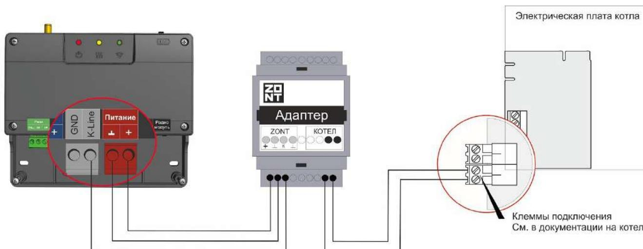
Допускается подключение только одного адаптера цифровой шины.
