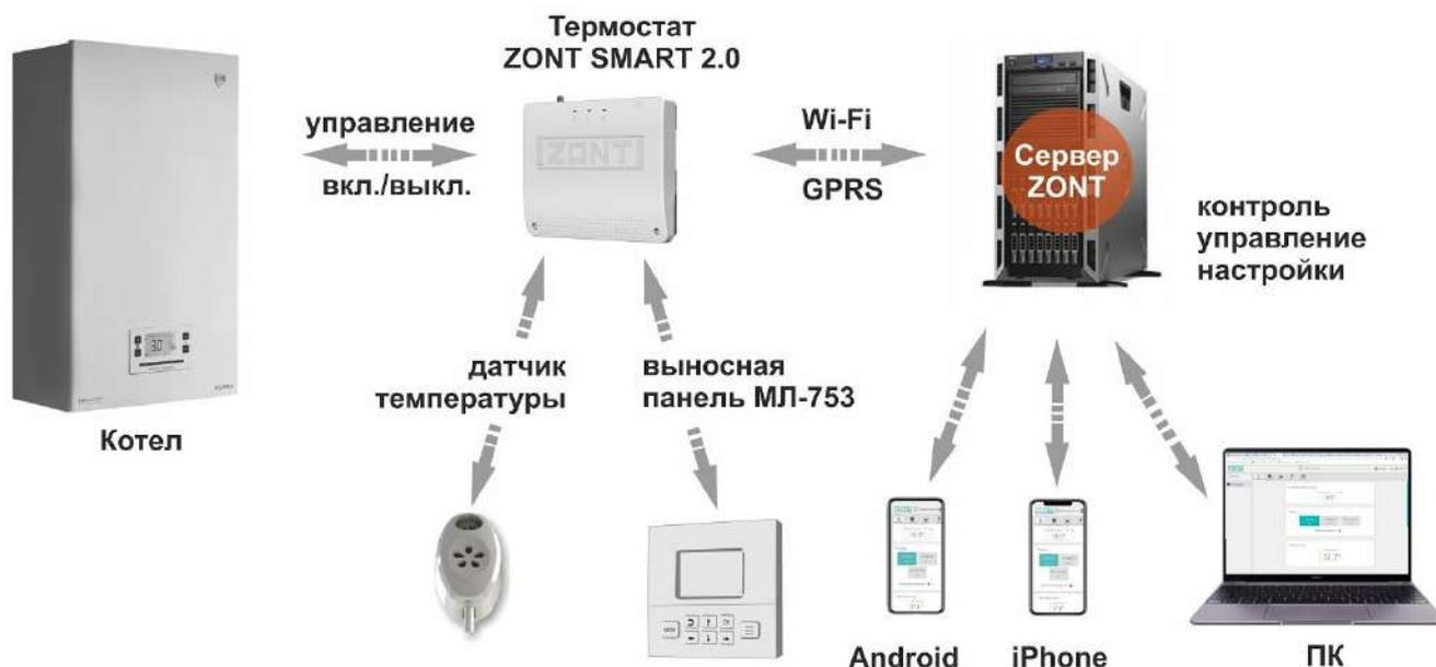
**Настройка** Контроллера производится следующими способами:
