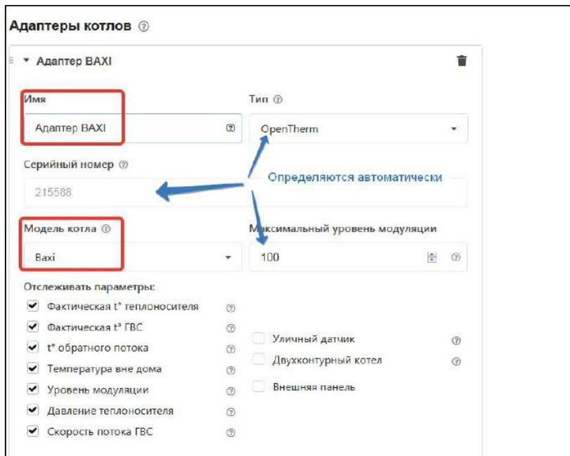
Укажите в контуре Котел исполнительное устройство, используемое для управления котлом. В качестве источника информации о фактической температуре теплоносителя также укажите адаптер цифровой шины котла. Задайте температурный диапазон работы котла, который должен соответствовать максимальному и минимальному значению, установленному в настройках котла.
